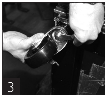
3 Die Rolle mit dem beigelegten Werkzeug festziehen.
