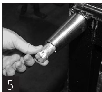
5 Das Fußende ist verstellbar, um das Ausrichten zu erleichtern.
