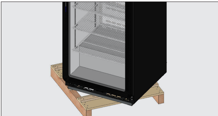
Afb. 4. Draai het apparaat op het pallet. Til de kast niet op aan het werkblad, de deuren, de laden of de roosters.
