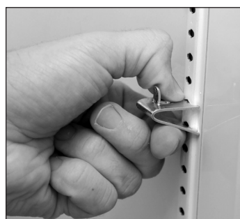
Afb. 3. Het kan zijn dat u voor de plaatsing de onderkant van de plankclip in moet knijpen of moet draaien.
