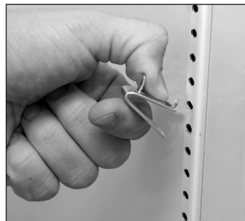
Afb. 1. De bovenste clip van de inlegbodem installeren.
